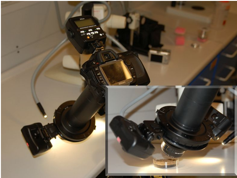
Figur 4. Til fotografering af springhaler bruger jeg en Nikon D80 og to SB-R200 Speedlight enheder med et Apo Rodagon N 50mm/2,8 forstørrelsesoptik for enden af et 20 cm bælg.
